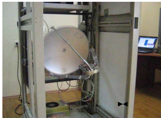
Рис. 2. Внешний вид системы радиовидения. Антенная система, матрица сенсоров, система позиционирования и охлаждения.
