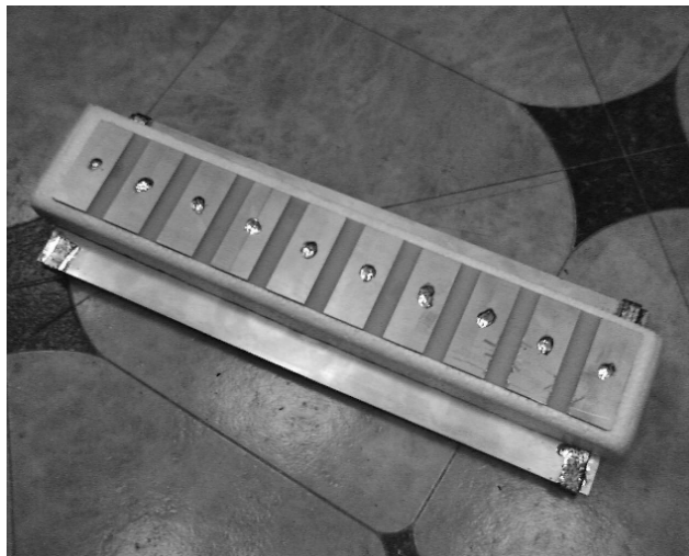
Рис. 1. Линейка электродов планарной системы для электрополевой томографии.
