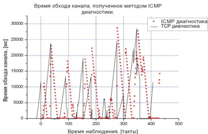
Рис. 2. Сопоставление результатов ISMP и RTT диагностики канала.
