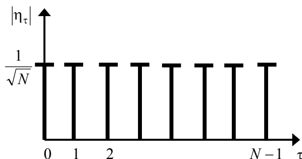
Рис. 1. Примерный вид нормированной взаимной корреляционной функции ( |\eta_{\tau}| - нормированная ВКФ, N - размерность фазокодированной последовательности, \tau - временной сдвиг).
