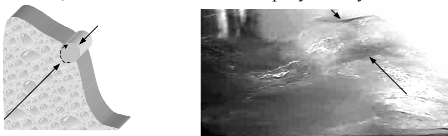
Рис. 2. Силы, действующие на единицу поверхности вихря со стороны воды и воздуха. Справа на кадре видеозаписи виден вихрь, вылетевший с заднего склона волны навстречу потоку.
