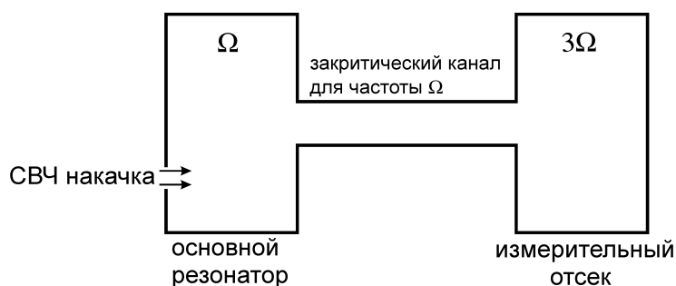
Рис. 1. Схема резонатора для детектирования третьей гармоники.
