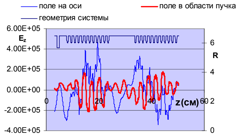
Рис. 2 Распределение полей в двухсекционном генераторе на сверхразмерном волноводе. U=740 кВ, I=10 кА.
