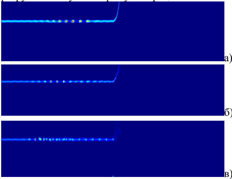
Рис. 2. Распределение плотности электрического заряда в моменты времени, соответствующие 3 нс (а), 5 нс (б) и 9 нс (в) после влета пучка в пространство взаимодействия.
