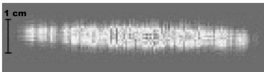
Рис. 1. Измеренное распределение амплитуды акустического давления на расстоянии z=2 см от излучающей поверхности.
