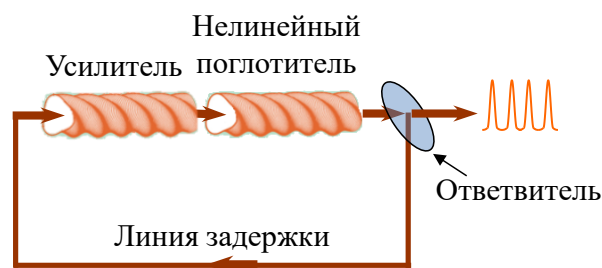
Рис. 1. Схема 3-х мм УКИ генератора на основе двух связанных винтовых giro-ЛБВ.
