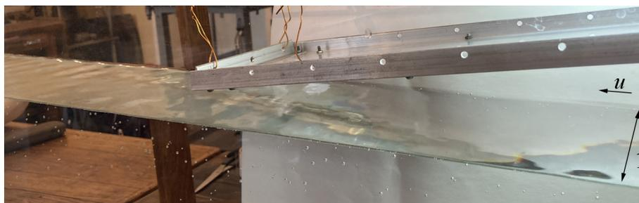
Рис. 1. Генерация волн в тормозящемся потоке воздуха (без крыши), отсутствие волн в ускоряющемся потоке (под крышей). 1 – гладкая поверхность воды
