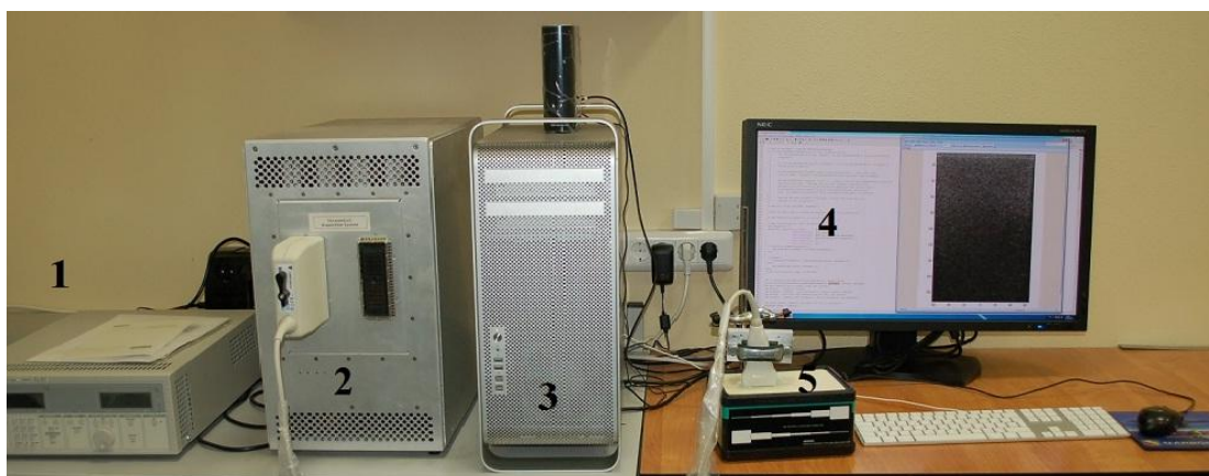
Рис.1. Акустическая система Verasonics: блок питания (1), управляющий блок (2), компьютер (3), монитор (4), исследуемый фантом и ультразвуковой датчик (5)
