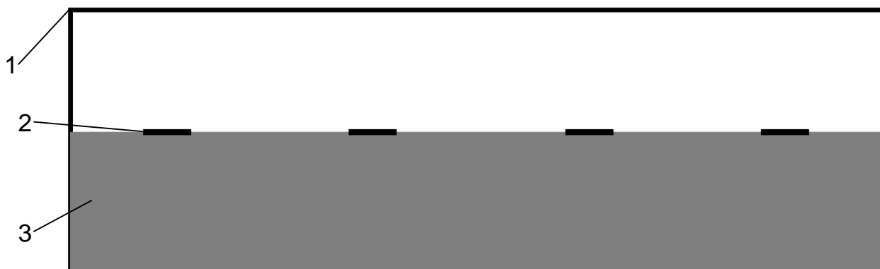
Рис. 1. Принципиальная схема изитрона. 1 - стенка волновода, 2 - отрезок металлической проволоки, 3 - диэлектрический наполнитель.
