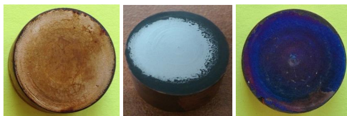
Рис1. 1.Подложка из меди, 2.нанесенное аморфное покрытие из хрома, 3. Поликристаллическое отожженое покрытие.
