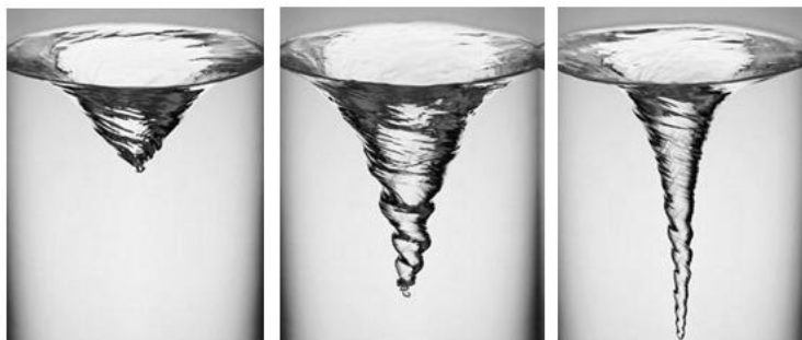
Рис. 4. Образование торнадо в воде при использовании вместо активной среды закрутки поверхностного слоя пластинкой с лопастями. Наибольшая скорость вращения на рис. 4 справа, наименьшая – слева.
