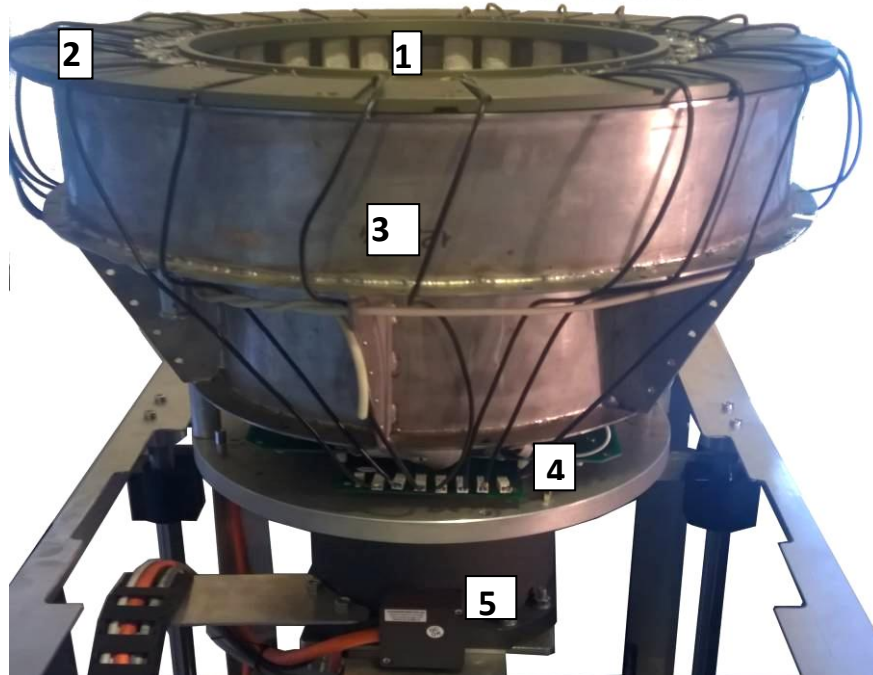
Рис. 1. Внешний вид кольцевой многоканальной антенной решетки: 1 – пьезоэлектрические префоизлучающие преобразователи; 2 – пластина с посадочными местами для преобразователей в заданных угловых позициях; 3 – емкость для иммерсионной жидкости; 4 – система сбора данных, состоящая из базовой (материнской) платы, четырех дочерних плат (с проводами от префоизлучающих преобразователей), а также платы накопления и обмена данными с ЭВМ; 5 – поворотный двигатель.
