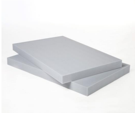
Рис. 2. а) Фотография меламин Basotect; б) Частотная зависимость коэффициента отражения, синяя линия – эксперимент, красная – теория Био.
