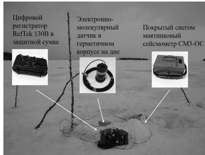
Рис. 2. Фотография полевых работ на льду озера с указанием используемой аппаратуры
