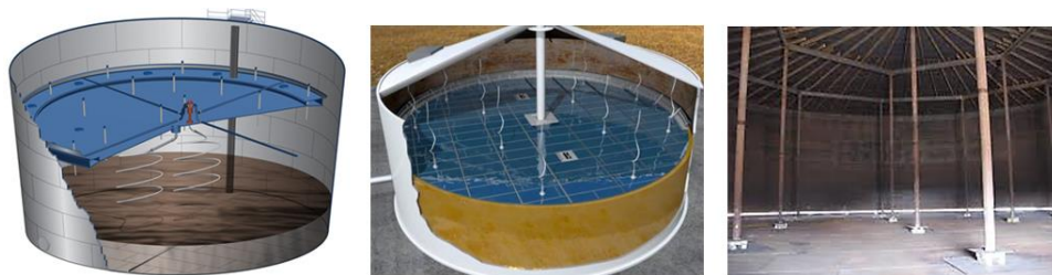
Рис.1. Принципиальная конструкция хранилищ с плавающей крышей (а), с закрытой плавающей крышей (б) и с фиксированной крышей (в).
