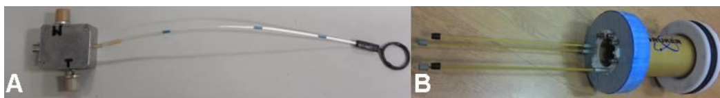
Рис. 1. Приемно-передающие катушки для ядер дейтерия (А) и для ядер фтора (В).
