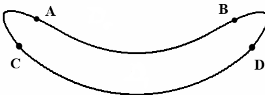
Рис.1. Сечение модельного параболического коллиматора с эллиптическими скруглениями.
