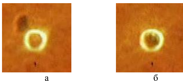
Рис.4 Захват кольцевой ловушкой частицы Al_2O_3 : а – частица рядом с ловушкой, б – частица удерживается ловушкой.
