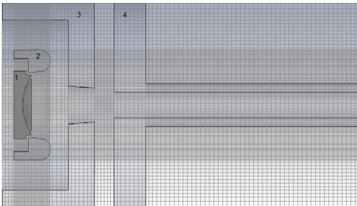
Рис.1. Схема электронной пушки преобразователя и распределение ячеек сетки для расчёта электронной эмиссии. 1 – катод, 2 – фокусирующий электрод, 3 – управляющий электрод, 4 – анод.
