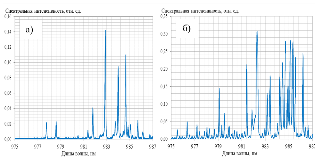
Рис. 1. Спектральные характеристики мощных ЛД модели KLM-H980-120-5: а) на начальном этапе эксплуатации; б) через 90 часов ускоренных испытаний на старение
