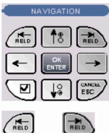
Клавиши клавишной панели **NAVIGATION** (НАВИГАЦИЯ) используются для перемещения курсора по экрану анализатора цепей и экрану справочной системы Help, и доступна к элементам управления на экране.
