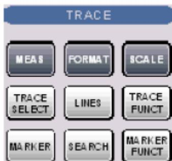
Клавиши с клавишных панелей **TRACE** (КРИВАЯ), **CHANNEL** (КАНАЛ) и **DISPLAY** (ЭКРАН) позволяют настраивать соответствующие их названиям параметры анализатора. Каждая из клавиш соответствует выпадающему меню или команде меню графического интерфейса пользователя.
