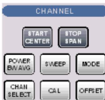
Клавиши клавишной панели **CHANNEL** (КАНАЛ) открывают доступ ко всем параметрам измерительных каналов и функциям активации, изменения настроек и сохранения различных измерительных каналов.
