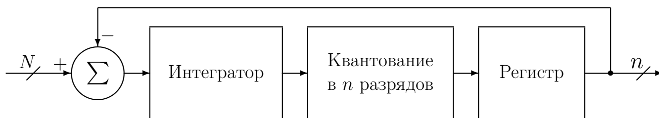
Рис. 12.3. Блок-схема сигма-дельта модулятора цифрового сигнала
