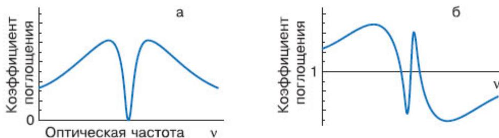
схематичное изображение спектрального хода коэффициента поглощения (а) и показателя преломления (б) атомной среды, регистрируемых пробным пучком в условиях электромагнитно-индуцированной прозрачности.  $\nu_0$  — резонанс ЭИП прозрачности, то есть частота пробного пучка, при которой разность частот пробного пучка и пучка накачки сравнивается с частотой перехода 1–2
