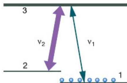
удивлением «обнаруживает», что среда под действием накачки приобретает новые свойства. Например, исчезает поглощение на переходе из заселенного основного состояния 1 в возбужденное состояние 3. Точное частотное положение точки прозрачности определяется условием равенства разности частот двух оптических полей частоте перехода 1–2.
