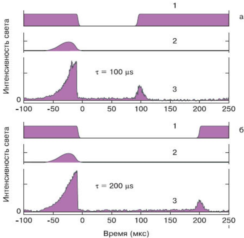
Наблюдение эффекта «остановки света» в кювете с парами рубидия на временных интервалах 100 мкс (а) и 200 мкс (б): кривые 2 и 3 — интенсивности волны пробного импульса на входе и выходе, кривая 1 — интенсивность пучка накачки.
